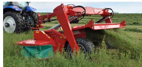
Работа с левой или правой стороны - устанавливается из кабины трактора.
