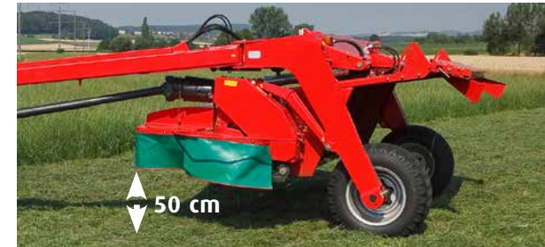
Клиренс 50 см из-за конструкции тележки.
