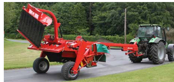
При транспортировке модели СТ/CR подвешиваются в центральном положении за трактором.
