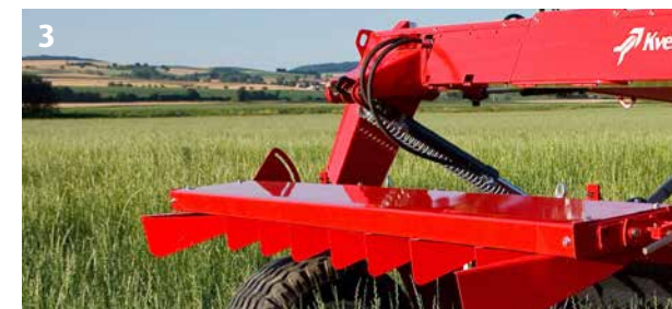
3 Снимите 2 отклоняющие створки, и вы готовы косить.
