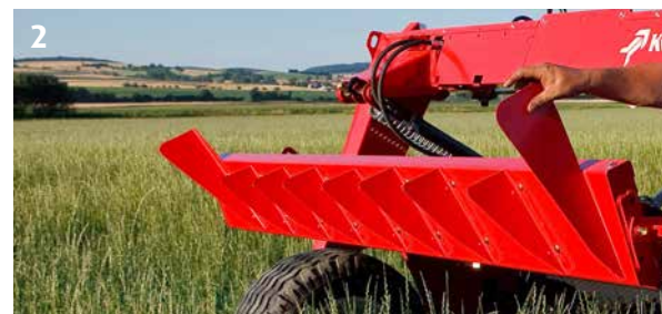
2 Переключение от валкования к укладке в расстил выполняется просто. Задняя пластина поворачивается на 180° (никаких инструментов не требуется).
